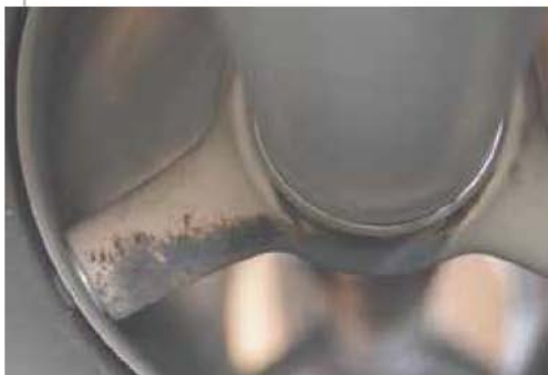
图3-4-5 滑动三支柱绝缘子放电痕迹
