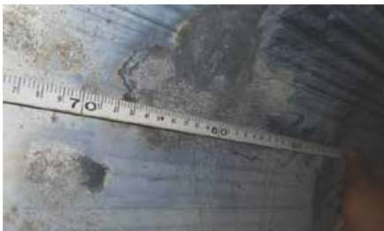
图3-4-6 导电杆对应位置的壳体内壁电弧烧灼痕迹
