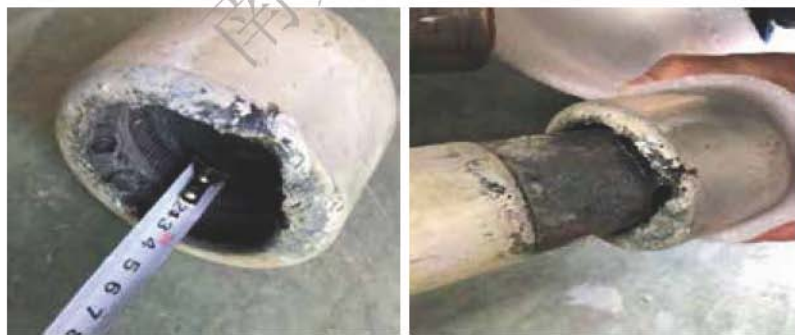
图3-3-2 导电杆与触头座插入深度测量
