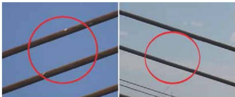
乙线B相导线放电点
