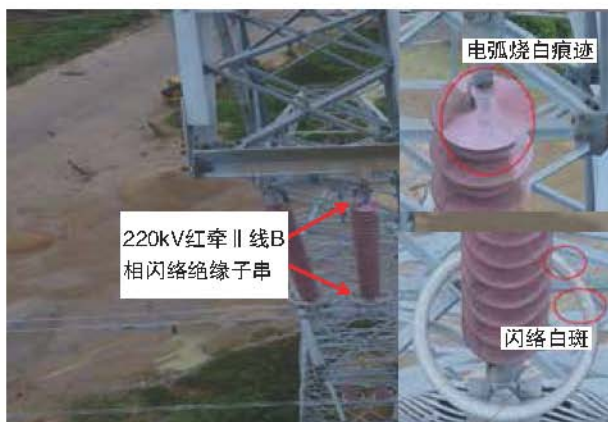
图3-5-8 220kV红牵II线N35塔B相复合绝缘子上有雷击灼伤点
