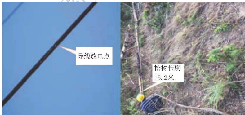
图3-2-11 #74塔+90米处A相导线放电点 图3-2-12 烧焦的松树
