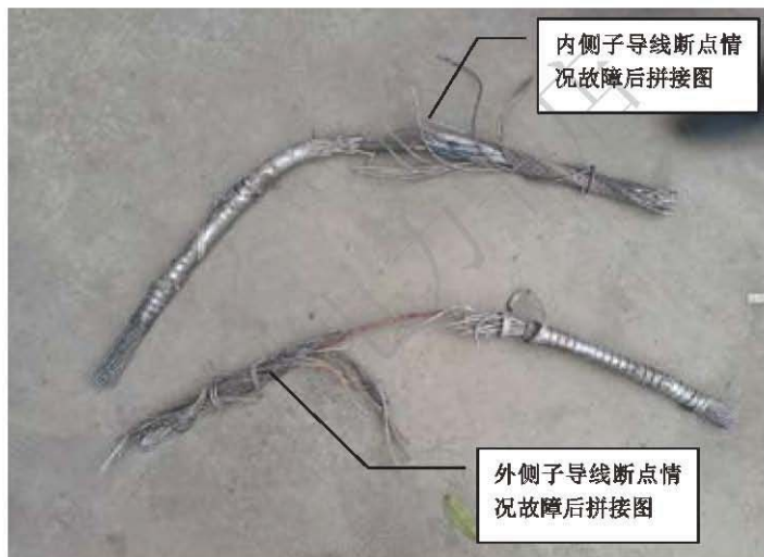
图3-18 内、外侧导线断点情况故障后拼接图
